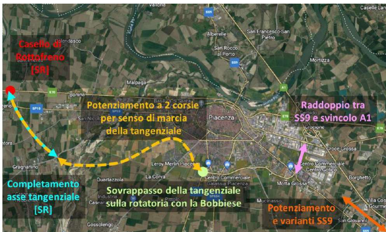
Figura 2.3.3 – Completamento e potenziamento della Tangenziale di Piacenza, schema degli interventi.
